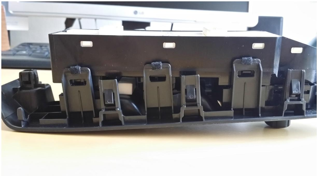
Jetzt den Schaltereinsatz aus der Halterung aushebeln, dazu die insgesamt 6 Nasen (3 auf jeder Seite) mit einem kleinen Schraubendreher leicht aufhebeln und den Einsatz nach oben rausnehmen.
