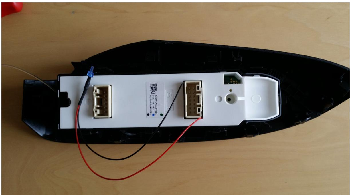
Zum Schluß noch die LED und die Lichtfaser mit dem Schrumpfschlauch verbinden, dabei darauf achten das die LED bündig auf der Lichtfaser aufliegt.
